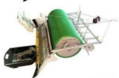
All Nožový rozrušovač, válec, uhlazovač, boční křídélka a 2 stopaři
