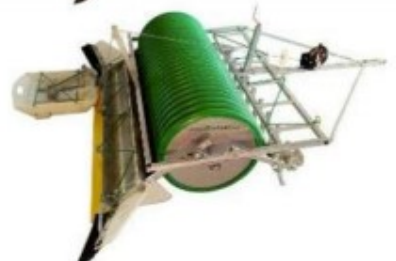
Max Nožový rozrušovač, válec, uhlazovač, boční křídélka a 1 stopař
